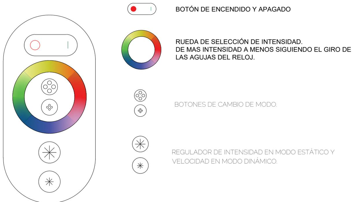
PARA EMPAREJAR EL CONTROLADOR CON SU RECEPTOR PULSE EL BOTON DE DIRECCIONAMIENTO DEL TSL 2501XX Y A CONTINUACIÓN PRESIONE EL BOTON DE ENCENDIDO. EN EL MOMENTO QUE PARPADEE, EL CONTROLADOR ESTA EMPAREJADO.
